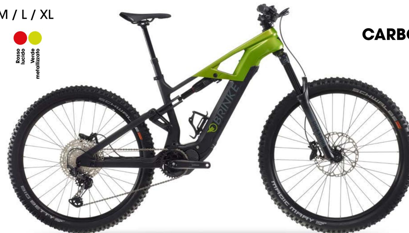
**+** Telaio Full Carbon con 160mm di escursione posteriore.
